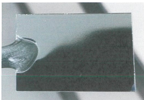
ภาพที่ 4.5 แผ่นอลูมิเนียมหลังผ่านการขัดผิวโลหะด้วยไฟฟ้าเคมีเคมีใช้ความต่างศักย์ไฟฟ้าคงที่ 10 โวลต์ เวลา 5 นาที
