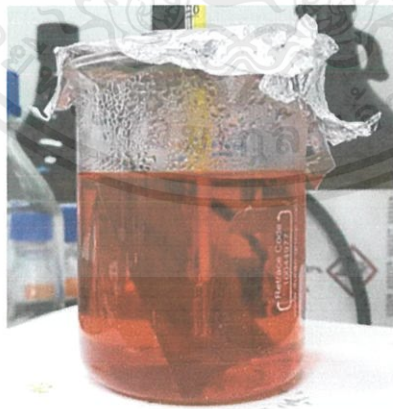
ภาพที่ 3.4 การกัดด้วยสารเคมีโดยใช้กรดฟอสฟอริก 6% ผสมกับกรดโครมิก 2%
