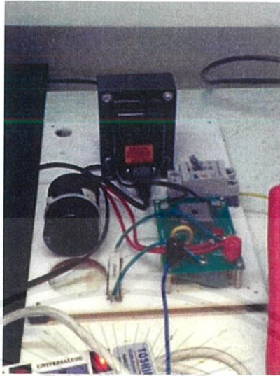
ภาพที่ 3.13 หม้อแปลงไฟ AC to DC
