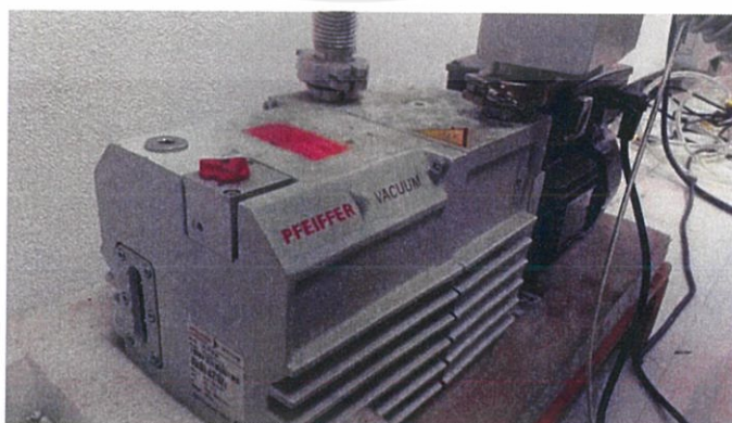
ภาพที่ 3.6 Rotary Pump ที่ใช้ในระบบ จากบริษัท PFEIFFER Vacuum
