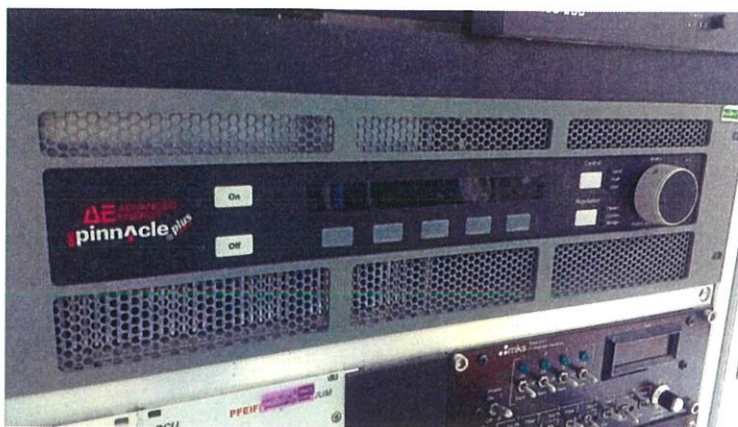
ภาพที่ 3.8 Power Supply ที่ใช้ในระบบ จากบริษัท The Advanced Energy รุ่น Pinnacle Plus+
