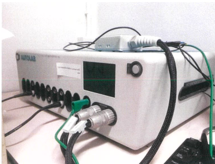
ภาพที่ 3.17 เครื่องมือวิเคราะห์ Potentiostat
