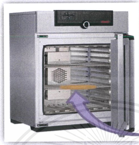
ภาพที่ 3.11 แสดงการอบแผ่นซิลิกอนที่ทำการเท PDMS แล้ว
