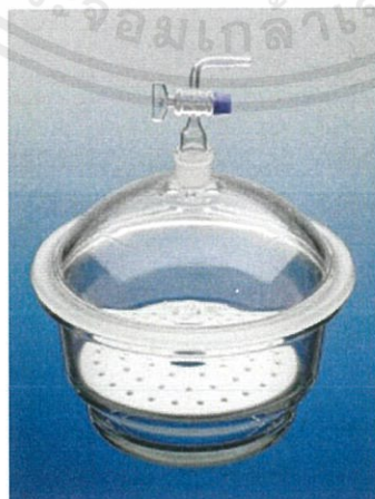
ภาพที่ 3.8 โถดูดอากาศ (Desiccator) ที่ใช้ในการไล่ฟองอากาศที่เกิดจากการคน PDMS
