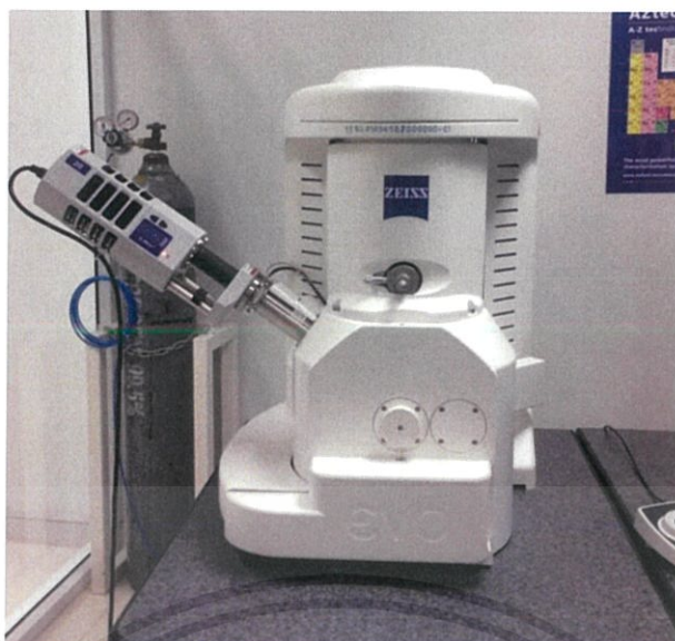
ภาพที่ 3.7 แสดงกล้องจุลทรรศน์อิเล็กตรอนแบบส่องกราด (scanning electron microscope, SEM)
