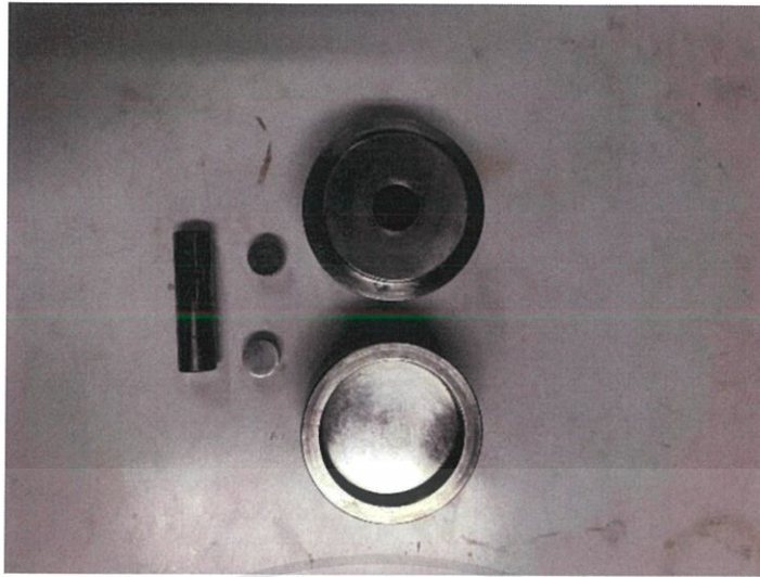
ภาพที่ 3.5 แสดงแม่พิมพ์อัดสาร
