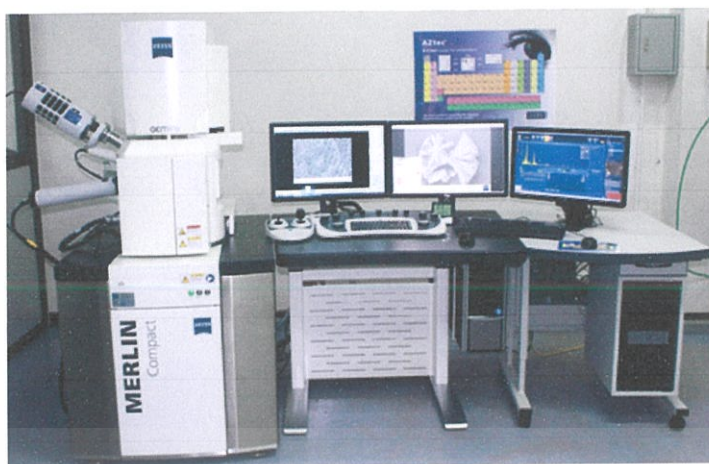
ภาพที่ 2.42 แสดงภาพส่วนประกอบของเครื่องกล้องจุลทรรศน์อิเล็กตรอนแบบส่องกราดชนิดฟิลด์ อิมิชชัน (Field Emission Scanning Electron Microscope: FE-SEM)
