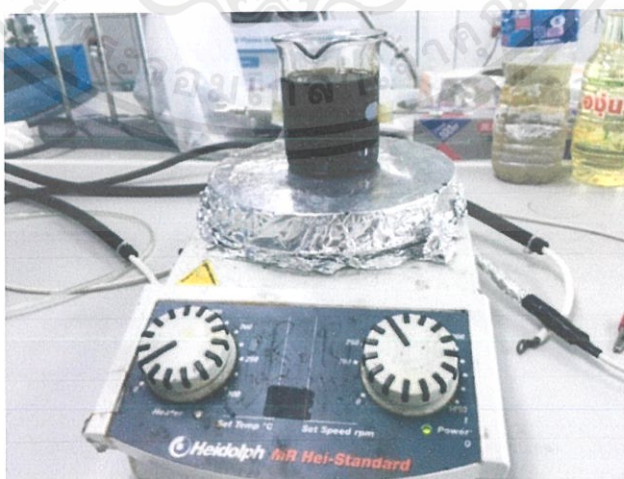
ภาพที่ 3.3 แสดงการนำน้ำมันเครื่องที่ผ่านการใช้งานแล้วที่ผสมกับเบนซินไปผ่านกระบวนการพลาสมาวิภาคของเหลว (SPP) โดยไปการปั่นกวนด้วยเครื่องปั่นกวน (Stirrer)
