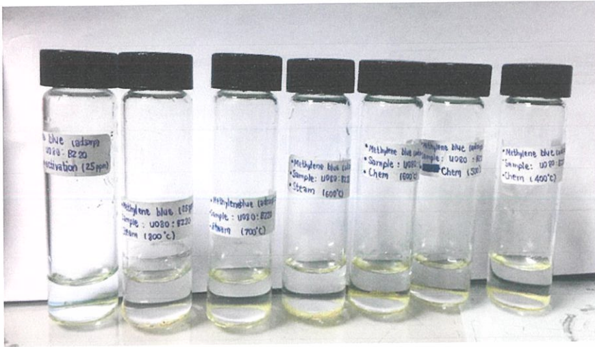
ภาพที่ 5 (ก) แสดงการดูดซับสีของเมทิลีนบลูที่ความเข้มข้น 25 ppm หลังจากนำไปทำการทดสอบการดูดซับด้วยถ่านกัมมันต์ที่เงื่อนไข ดังนี้ BA, ST800, ST700, ST600, CA600, CA500, และ CA400 (หลังจากทำการกรอง)
