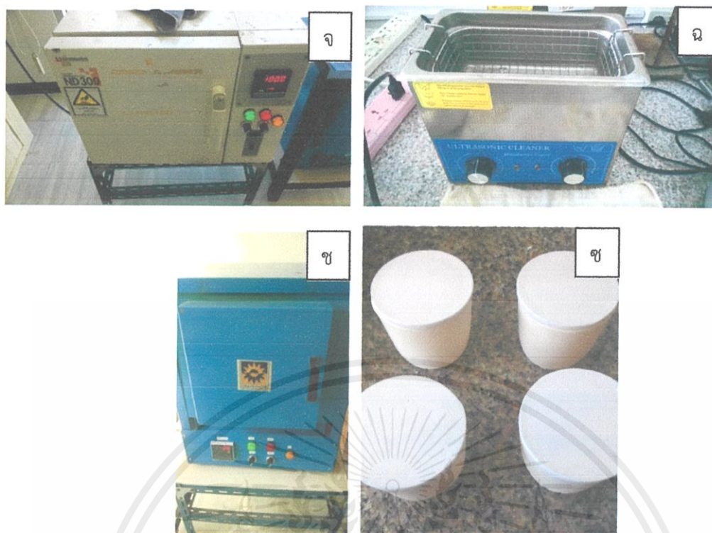
ภาพที่ 3.2 (ต่อ) อุปกรณ์ที่ใช้ในงานวิจัย (ก) หม้ออบพลาสติก (ข) เครื่องหมุนสายพานสำหรับบัด (ค) เครื่องซังสาร 3 ตำแหน่ง (ง) ลูกบดเซอริโคเนียออกไซด์ (จ) เตาอบความร้อน (ฉ) เครื่องโซนิกเคดด์ (ช) เตาเผา (ซ) ถ้วยเผาสาร
