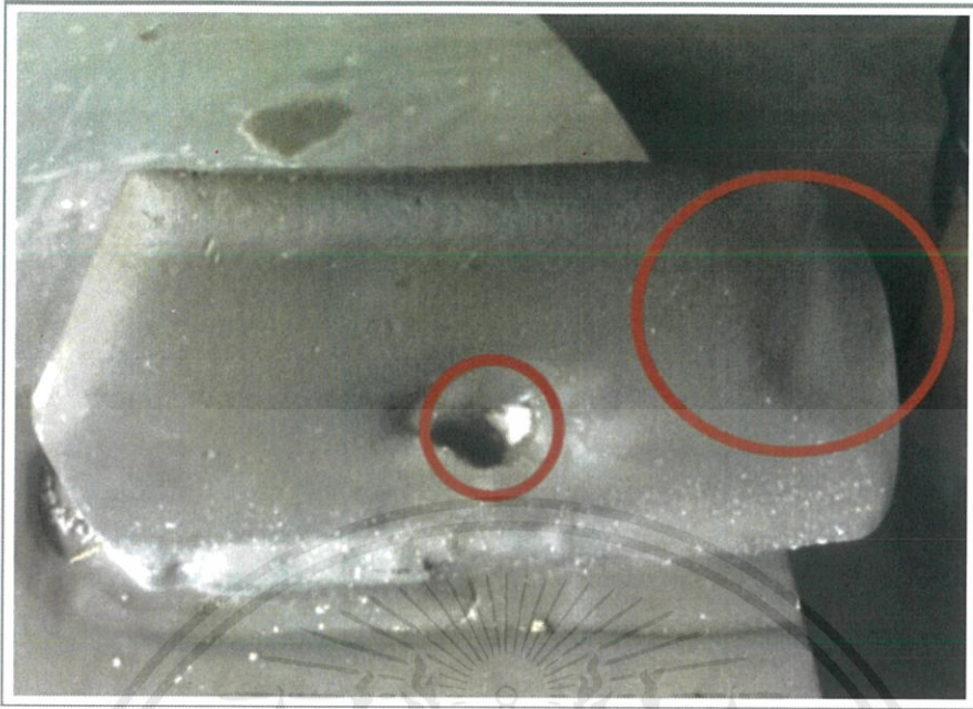
รูปที่ 3.8 ลักษณะการสึกกร่อนของค้อนบดหินปูน
