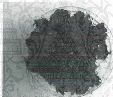
ภาพที่ 3.20 ดอกธูปฤาษีที่ผ่านกระบวนการไฮโดรเทอร์มัล
