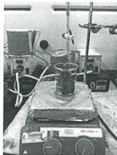
ภาพที่ 3.26 การเจือสารละลายโลหะบนตัวรองรับดอกธูปฤๅษีด้วยกระบวนการชุบเปียก
