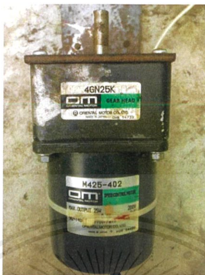
ภาพที่ 3.3 ชุดมอเตอร์กระแสสลับและหัวเกียร์
