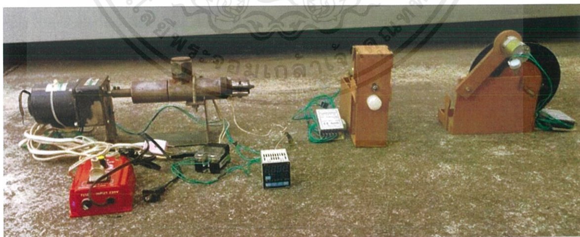
ภาพที่ 4.1 ลักษณะของระบบอัดรีดเส้นพลาสติก
