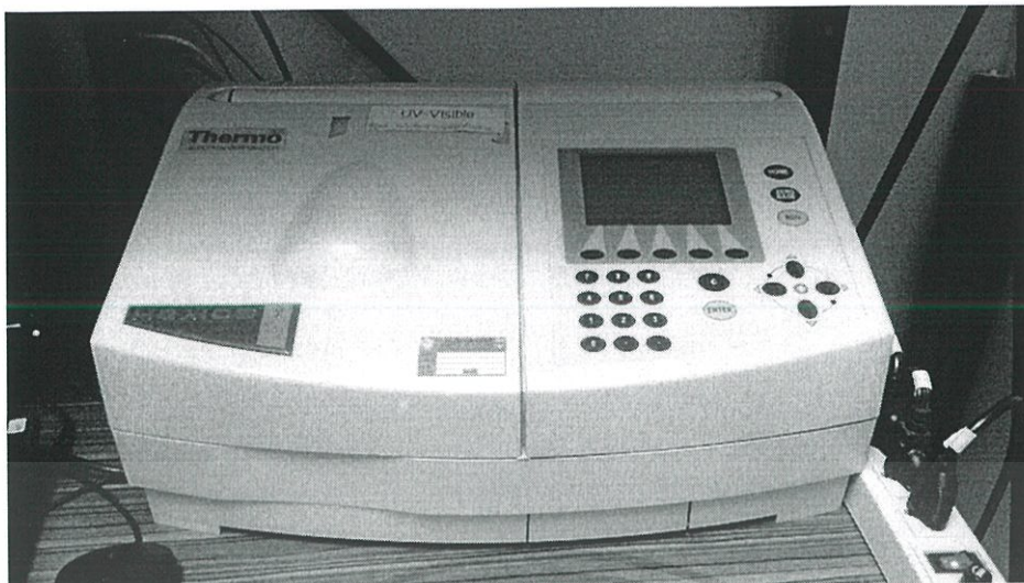
ภาพที่ 3.12 เครื่องยูวี-วิส สเปกโตรโฟโตมิเตอร์ (UV-VIS spectrophotometer)
