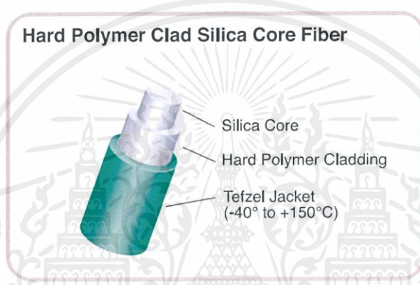
ภาพที่ 3.1 โครงสร้างของไฟเบอร์ออปติก (Fiber-optic) รุ่น FT-400 UMT (OH HIGH) ที่ใช้
