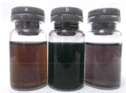
ภาพที่ 2.10 (a) สารละลายกราฟีนออกไซด์ (1 mg/ml), (b) และ (c) สารละลายรีดิวซ์กราฟีนด้วย
