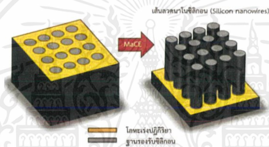
ภาพที่ 1.1 การสร้างเส้นลวดนาโนซิลิกอนจากการกัดทางเคมีโดยใช้โลหะเป็นตัวเร่งปฏิกิริยา
