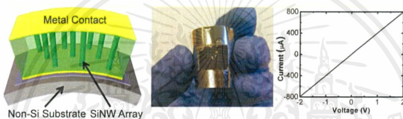
ภาพที่ 2.32 การประยุกต์ใช้งานเป็นฐานรองรับในอุปกรณ์อิเล็กทรอนิกส์ที่สามารถโค้งงอได้ [45]
