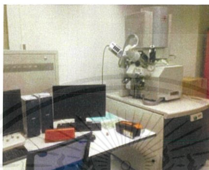
ภาพที่ 3.2 กล้องจุลทรรศน์อิเล็กตรอนแบบส่องกราดพร้อมระบบวัดธาตุเชิงปริมาณ รุ่น Versa 3D ของบริษัท FEI
