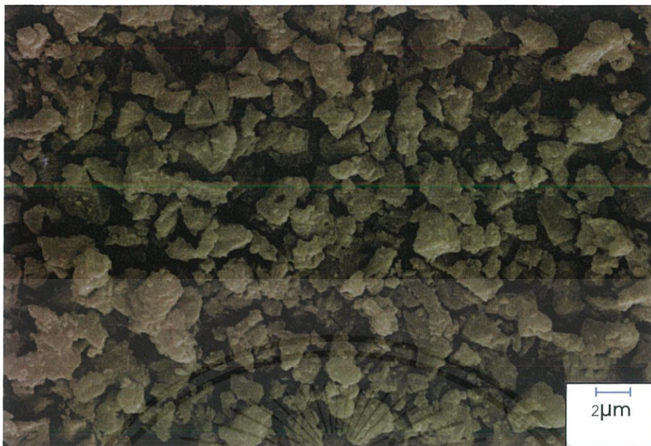
ภาพที่ 4.4 แสดงลักษณะพื้นที่ผิวเปลือกไข่ที่เผาที่อุณหภูมิ 1,000 องศาเซลเซียส
