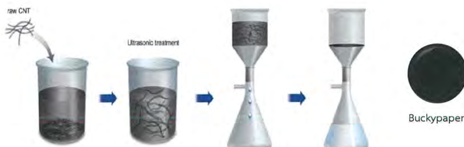
ภาพที่ 2.12 ภาพแสดงการจำลองกระบวนการการสร้างแผ่นกระดาษคาร์บอนด้วยวิธีการกรองด้วยสุญญากาศ (Vacuum filtration method) 18
