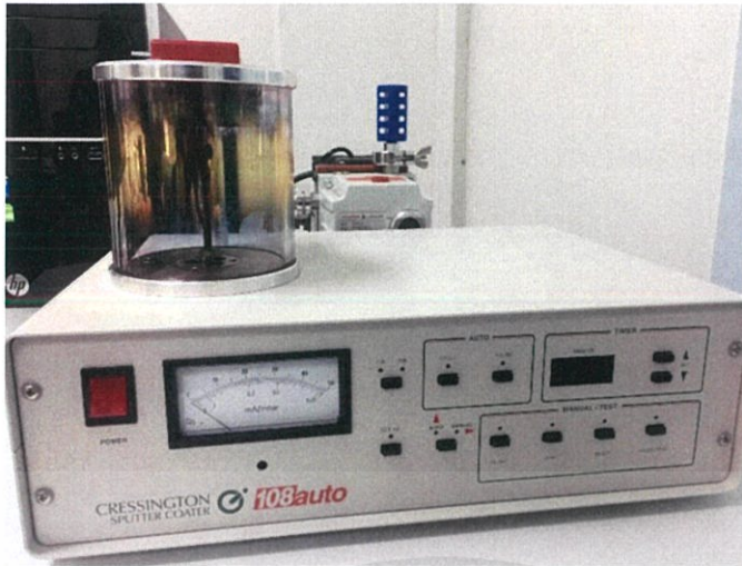
ภาพที่ 3.12 เครื่องที่ใช้เคลือบผิวหน้าด้วยทองคำ
