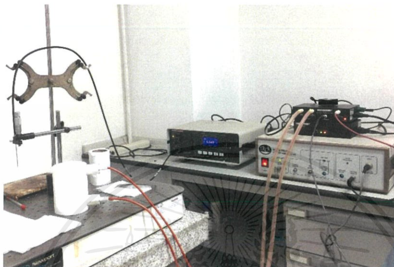
ภาพที่ 3.15 ระบบทดสอบวัสดุเฟอร์โรอิเล็กทริก
