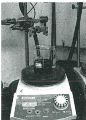
รูปที่ 3.54 ผสมสารละลายโลหะไนเตรตเข้ากับตัวรองรับคาร์บอน
