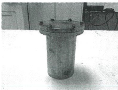
รูปที่ 3.49 นำภาชนะเทฟลอนใส่ลงในถังปฏิกรณ์ไฮโดรเทอร์มัลและนำถังปฏิกรณ์เข้าสู่ตู้อบ
