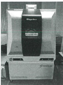
รูปที่ 3.34 เครื่องวิเคราะห์การเลี้ยวเบนรังสีเอกซ์
