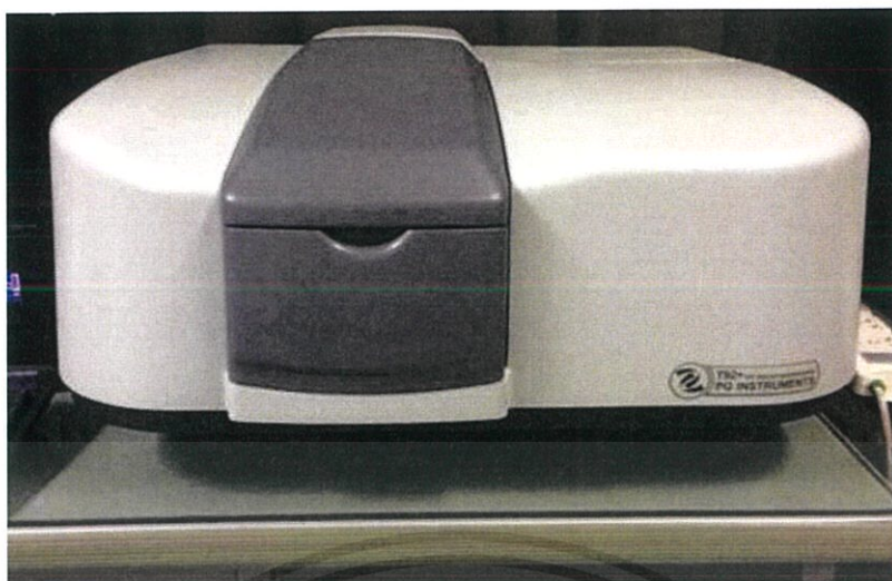
ภาพที่ 3.6 เครื่องยูวี-วิสิเบิล สเปกโทรโฟโตมิเตอร์ ยี่ห้อ PG instruments ชื่อรุ่น T92+
