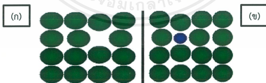
ภาพที่ 2.12 (ก) ลักษณะช่องว่างออกซิเจน และ (ข) การแทนที่ของฟลูออรีน (สีน้ำเงิน) [34]
