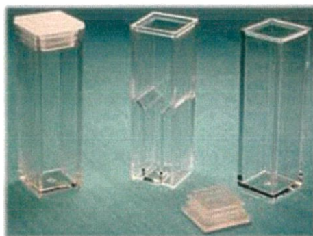
ภาพที่ 2.23 ลักษณะของคิวเวตต์แบบต่างๆ [43]
