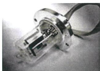
ภาพที่ 2.21 (ซ้าย) หลอดดิวเทอเรียม และ (ขวา) หลอดทังสเตน [43]
