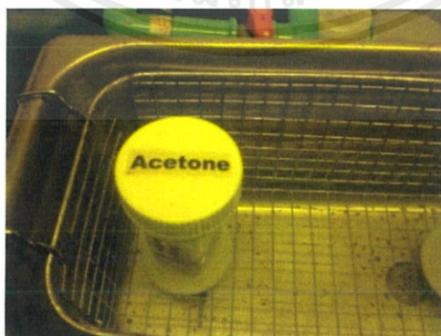
รูปที่ 3.14 ทำความสะอาดด้วยเครื่องล้างความถี่สูง โดยใช้ของเหลวอะซิโตน
