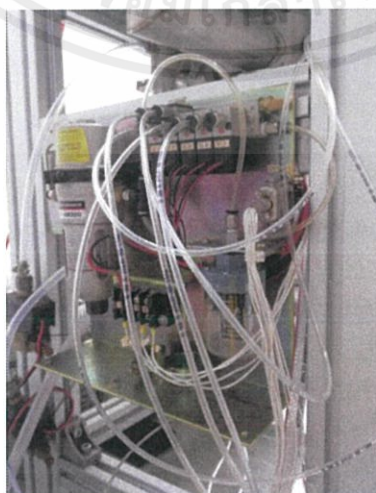
รูปที่ 3.14 วาล์วควบคุมทิศทาง เครื่องกรองอากาศ และเซ็นเซอร์วัดแรงดันลม
