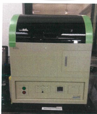
ภาพที่ 3.20 เครื่องวิเคราะห์ความเป็นกรดด้วยเทคนิค NH 3 -TPD
