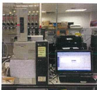
ภาพที่ 3.28 เครื่อง Gas chromatography
