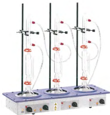
ภาพที่ ข.19 อุปกรณ์ชุดวิเคราะห์ไขมัน (Soxhlet apparatus)
