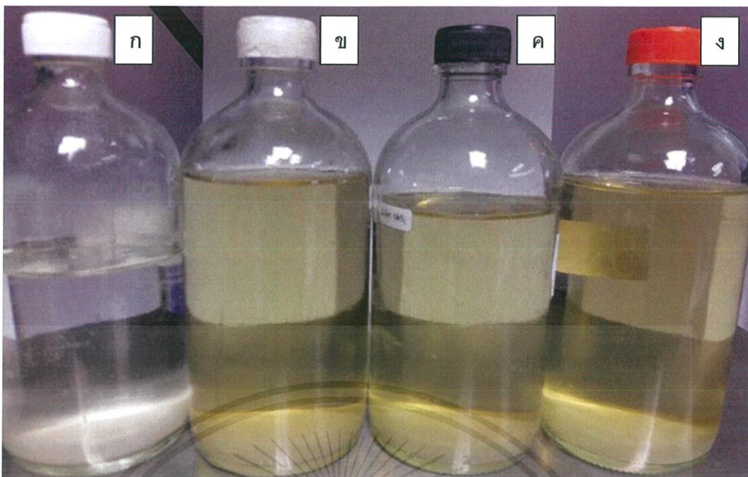
รูปที่ 3.8 สารละลายที่เกิดขึ้นหลังจากแร่ลูโคซีนตกตะกอนที่เจือไน (ก) บดในน้ำไร่ประจุ (ข) บดในกรดซัลฟิวริก (ค) บดในกรดซัลฟิวริกโดยเสริมคลื่นอัลตราโซนิกเป็นเวลา 1 ชั่วโมงและ (ง) 3 ชั่วโมง
