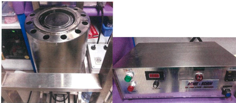
รูปที่ 3.2 เครื่องบดพร้อมระบบปล่อยคลื่นเสียงอัลตราโซนิก และตัวควบคุมการปล่อยคลื่นอัลตราโซนิก
