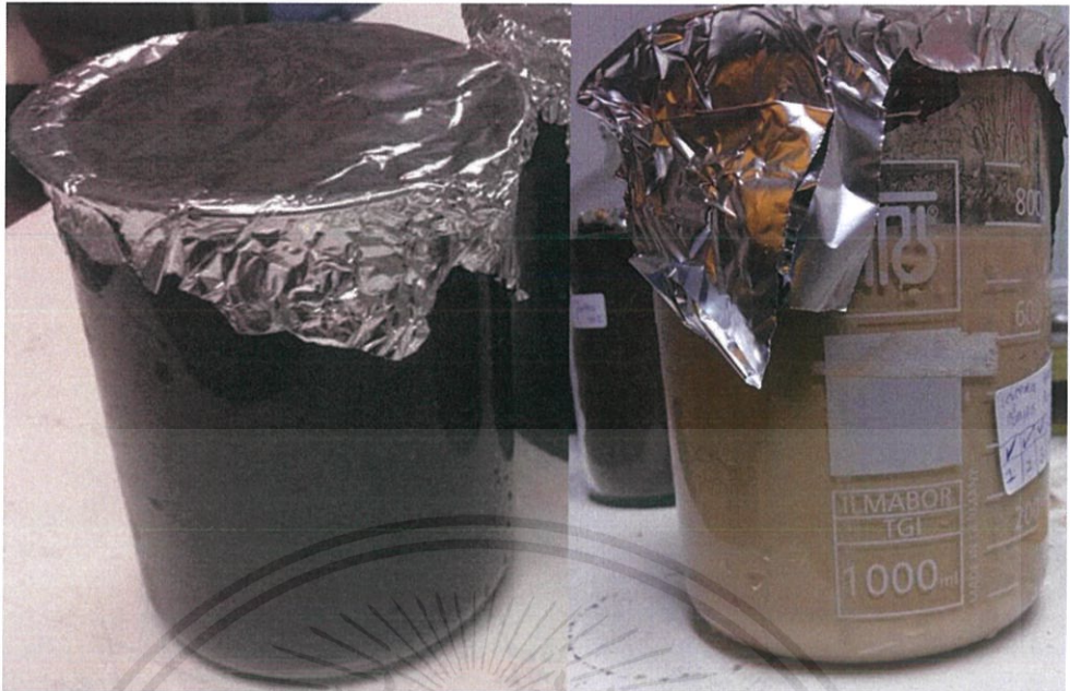
รูปที่ 3.5 แร่โอลิเมนิต์และลูโคซีนที่ได้หลังจากกระบวนการบดด้วยลูกบดพร้อมคลื่นอัลตราโซนิค
