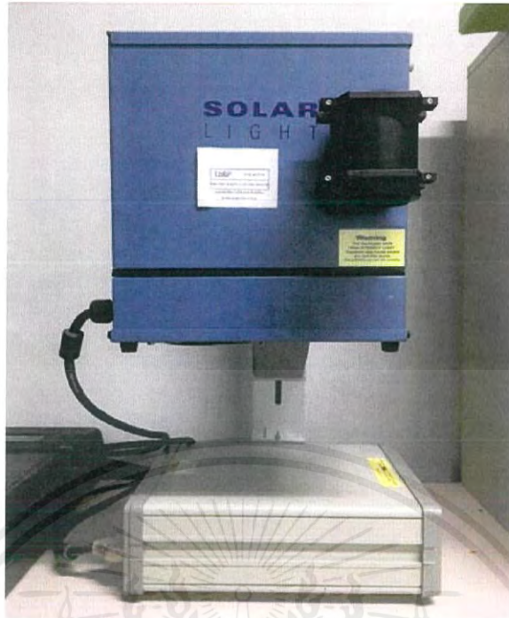
ภาพที่ 3.4 เครื่องจำลองแสงจากดวงอาทิตย์ (Solar simulator) รุ่น XPS300
