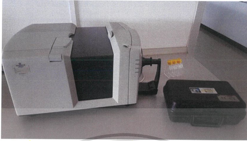
ภาพ ข.11 เครื่องวัดค่าสี (Hunter lab รุ่น Color Quest)
