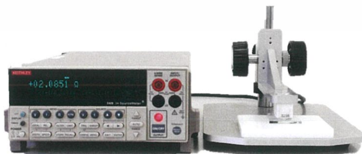
ภาพที่ 3.8 เครื่องวัดสภาพความต้านทานไฟฟ้าของบริษัท Quatek รุ่น QT-50 [52]
