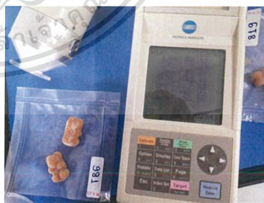
ภาพที่ ค.3.6 การวัดสีด้วย Chroma Meter (Minolta CR-400)
