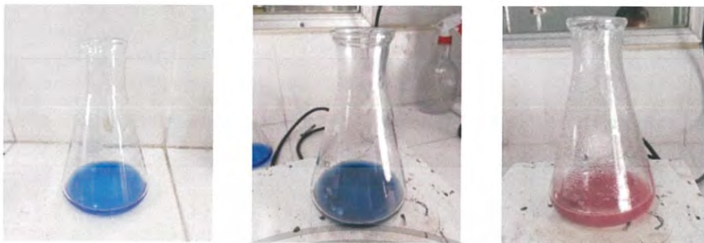
ภาพที่ ค.2.1 การหาค่ามาตรฐานของสารละลาย Fehling's โดยการไตเตรทขณะร้อน แสดงภาพสารละลายก่อนไตเตรท (ซ้าย), สารละลายไตเตรทขณะร้อน (กลาง) และสารละลายที่จุดยุติสีแดงอิฐ (ขวา) ตามลำดับ
