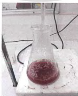
ภาพที่ ค.2.7 สารละลายไตเตรทขณะร้อน ที่จุดยุติจะได้สีแดงอิฐ
