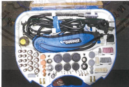
รูปภาพที่ 3.16 เครื่องเจียรสายอ่อน
