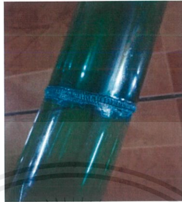
ภาพที่ 3.2.1.3.1 รูปประกอบการใช้เทคนิคบัดกรีบนชิ้นงานพลาสติก
