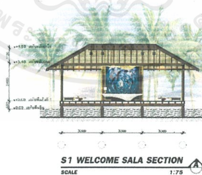
ภาพที่ 6.48 แสดงรูปตัดของอาคาร Welcome Sala
