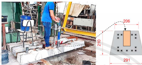
รูปที่ 2.6 การดำเนินการสกัดชิ้นส่วนตัวอย่างเพื่อทดสอบคอนกรีต [3]
