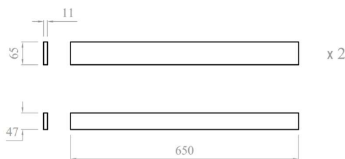
รูปที่ 4.2 พิกัดของไม้ที่ใช้ ในผิวด้านข้างของรูปสี่เหลี่ยมคางหมู ในหน่วยมิลลิเมตร
