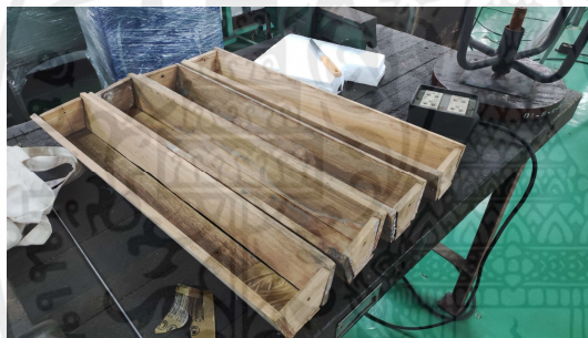
รูปที่ 4.3 และ 4.4 การเตรียมแบบหล่อไม้ และการเจาะรูที่หน้าตัดเพื่อติดตั้งเหล็กเส้น
