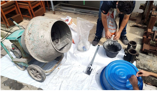
รูปที่ 4.7 และ 4.8 การเตรียมวัสดุดิบของคอนกรีต และคอนกรีตที่ผสมเสร็จ
