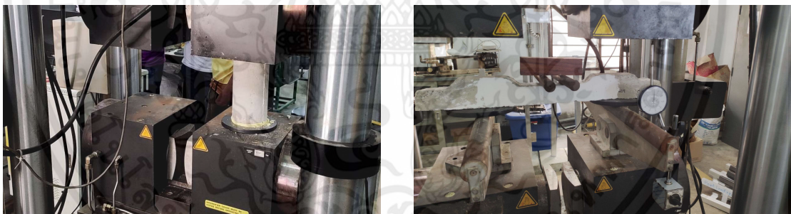
รูปที่ 4.11 และ 4.12 การทดสอบกำลังรับแรงอัดคอนกรีต และการทดสอบโมเมนต์ดัดบวก ที่กึ่งกลางหมอนรองราง
