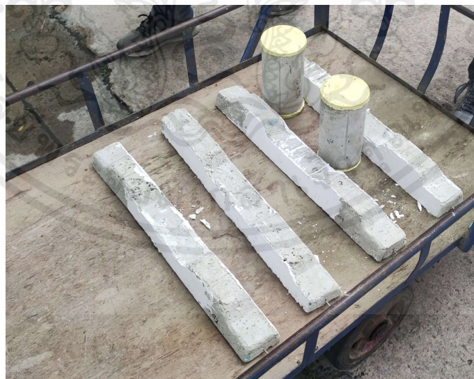
รูปที่ 4.10 หมอนรองรางที่พิจารณาตปริมาตรและอ้างอิงมุม 45 องศา และคอนกรีตรูปทรงกระบอกสำหรับการทดสอบ
