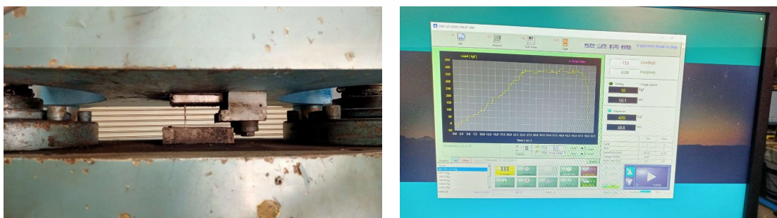
รูปที่ 4.13 และ 4.14 การทดสอบกำลังรับแรงดึงของเหล็กเส้นกลม และผลการทดสอบ
