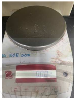
รูปที่ 3.6 เครื่องชั่งรุ่น Pioneer series , ยี่ห้อ OHAUS
