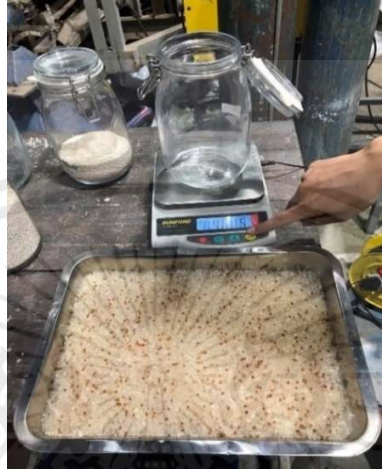
รูปที่ 3.23 นำสารดูดซับที่อบเสร็จแล้วออกจากเตาอบ
