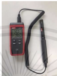
รูปที่ 3.16 เครื่องวัดอุณหภูมิและความชื้น
