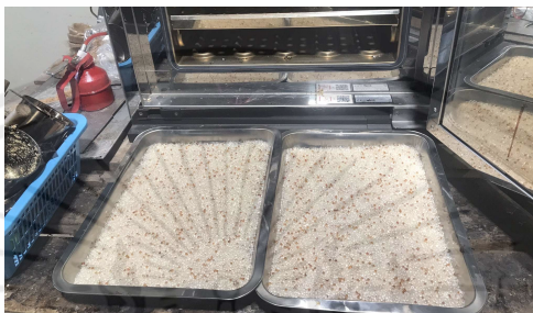
รูปที่ 3.20 การเตรียมสารดูดซับความชื้นเข้าเครื่องอบ
