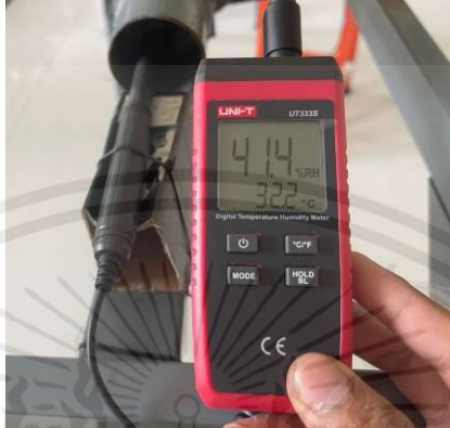
รูปที่ 3.33 เครื่องมือวัดค่าความชื้นสัมพัทธ์และค่าอุณหภูมิทางออกสารดูดซับ
