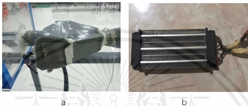
รูปที่ 3.8 ชุดเพิ่มอุณหภูมิอากาศ a) กล่องใส่ชุดลวดทำความร้อนแบบรังผึ้ง b) ชุดลวดทำความร้อนแบบรังผึ้ง
