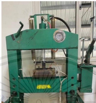
รูปที่ 3.36 การอัดขึ้นรูปจนวนกันความร้อน
