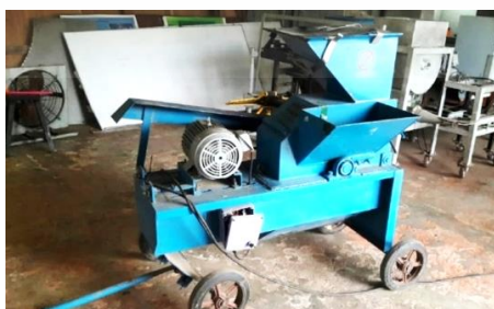
รูปที่ 3.13 เครื่องบดละเอียดมอเตอร์ขนาด 5 แรงม้า
