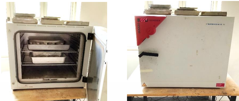
รูปที่ 3.40 อบขึ้นทดสอบที่อุณหภูมิ 105 องศาเซลเซียส
