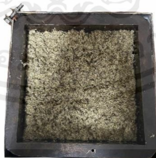
รูปที่ 3.35 ส่วนผสมใส่ลงในบล็อกเหล็กกล้าอัดขึ้นรูปจนวนกันความร้อน
