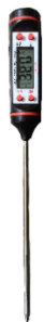
รูปที่ 3.24 เครื่องวัดอุณหภูมิแบบดิจิตอล
