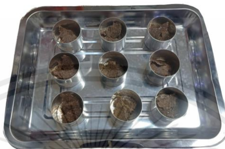
รูปที่ 3.38 บรรจุชิ้นงานทดสอบในถ้วยทนไฟเซรามิก
