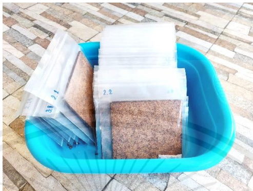
รูปที่ 3.42 ชิ้นงานทดสอบจำนวน 24 ชิ้น เก็บที่อุณหภูมิห้องระยะเวลา 28 วัน
