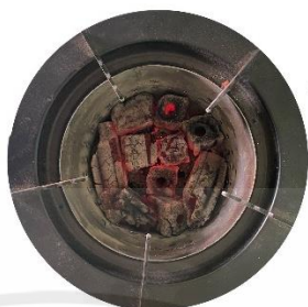
รูปที่ 3.53 ป้อนเชื้อเพลิงสำหรับการทดสอบและเริ่มจับเวลา
