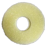
รูปที่ 3.46 ชิ้นงาน Insulation ขนาดเส้นผ่านศูนย์กลางภายใน 25 มิลลิเมตร และขนาดเส้นผ่านศูนย์กลางภายนอก 70 มิลลิเมตร
