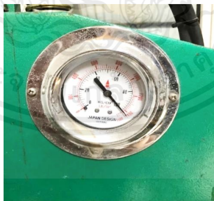
รูปที่ 3.2 เกจวัดความดันจากเครื่องอัดไฮดรอลิก
