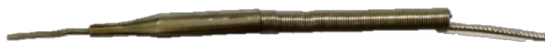
รูปที่ 3.6 เทอร์โมคัปเปิล Type K (TKS-S1-1.6X25-1M)
