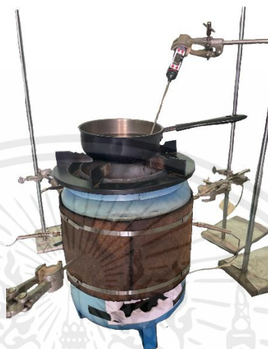
รูปที่ 3.51 ติดตั้งฉนวนและเครื่องวัดอุณหภูมิ
