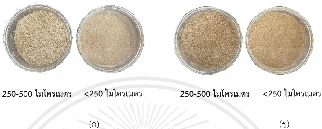
รูปที่ 3.31 (ก) เส้นใยผักตบ (ข) เส้นใยกาบหมาก แต่ละขนาดตามลำดับ
