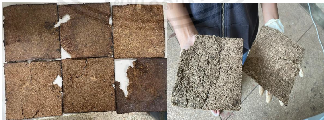
รูปที่ 4.1 ลักษณะกายภาพภายนอกของชิ้นงานทดสอบฉนวนกันความร้อนที่ขึ้นรูปไม่ได้
