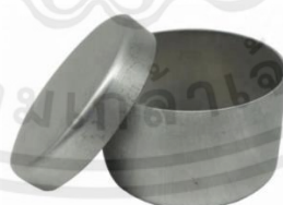
รูปที่ 3.18 ถ้วยเซรามิคขนาด 50 มิลลิลิตร
