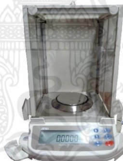
รูปที่ 3.15 เครื่องชั่งอิเล็กทรอนิกส์ทศนิยม 3 ตำแหน่ง
