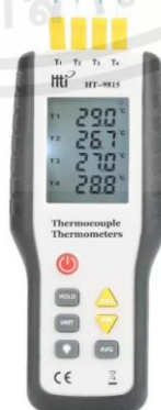
รูปที่ 3.26 เครื่องวัดอุณหภูมิ HT-9815 4 K – Type
