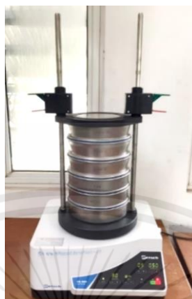
รูปที่ 3.14 เครื่องแยกขนาด รุ่น AS200 Retsch
