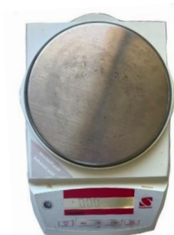
รูปที่ 3.16 เครื่องชั่งอิเล็กทรอนิกส์ทศนิยม 2 ตำแหน่ง
