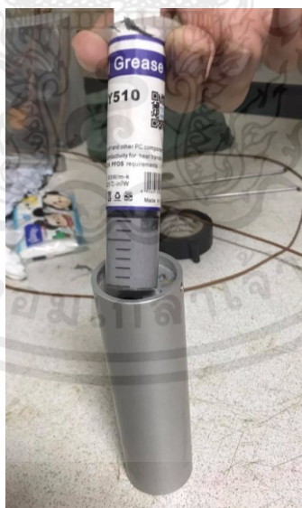
รูปที่ ก.3 ใส่ซิลิโคนนำความร้อน (Thermal grease) ในช่องที่จะทำการสอบเทียบเครื่องมือวัดอุณหภูมิ
