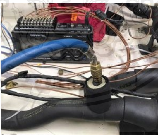
รูปที่ ง.2 นำสายสีน้ำเงินที่เกจแมนิโฟลด์ (Manifold gauge) เชื่อมต่อกับวาล์วบริการ (Service valve) ที่บริเวณทางออกชุดทดลอง (Test section) Nokkaew et al. [34]
