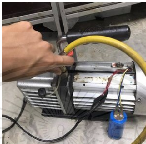
รูปที่ ง.1 นำสายสีเหลืองที่เกจแมนิโฟลด์ (Manifold gauge) เชื่อมต่อกับปั๊มทำสุญญากาศ (Vacuum pump) Nokkaew et al. [34]
