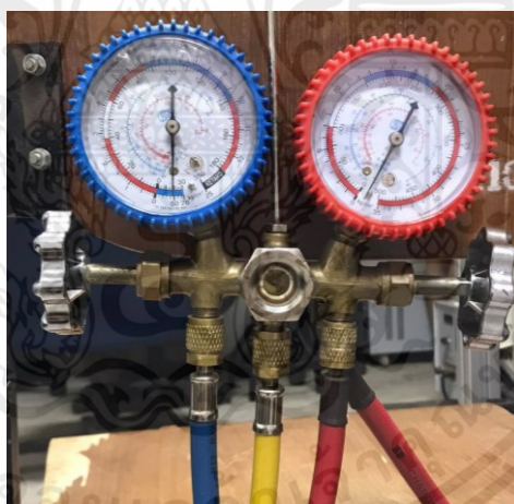
รูปที่ ง.4 เปิดวาล์วด้านความดันต่ำ (สายสีน้ำเงิน) ที่เกจแมนิโฟลด์ (Manifold gauge) Nokkaew et al. [34]
