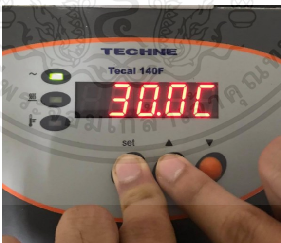
รูปที่ ก.5 ปรับตั้งอุณหภูมิที่ต้องการสอบเทียบที่เครื่องสอบเทียบอุณหภูมิ
