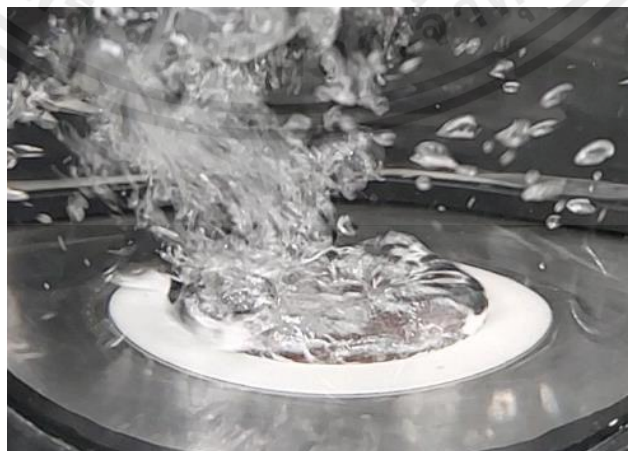
รูปที่ 2.9 แสดงการเดือดลักษณะอุณหภูมิต่ำของสารทำงานคือ saturated boiling
