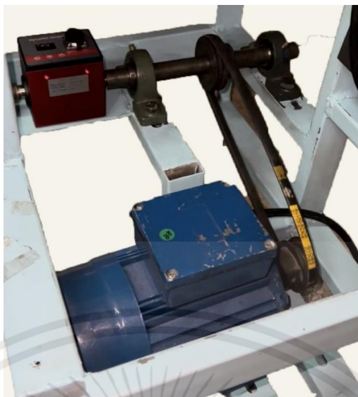
รูปที่ 3.23 การติดตั้งทอร์คเซ็นเซอร์
