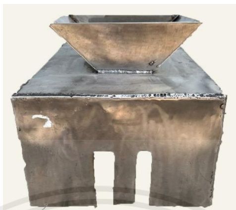
รูปที่ 3.30 ฝาครอบสแตนเลสด้านข้าง
