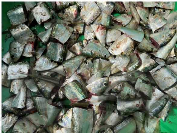
รูปที่ 4.20 ลักษณะของปลาเปิดที่ผ่านการสับเป็นชิ้น ความเร็วรอบ 1200 rpm
