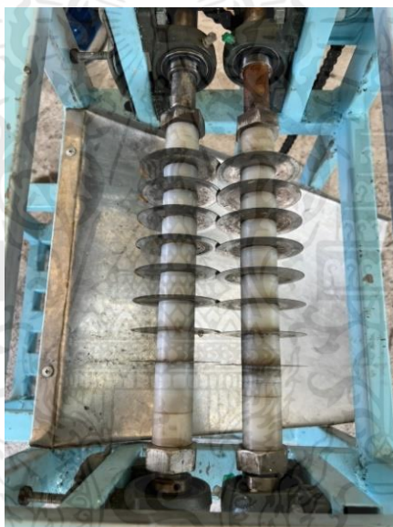
รูปที่ 3.17 ติดตั้งชุดใบมีดตัดเข้ากับโครงเครื่องสับปลาเปิด
