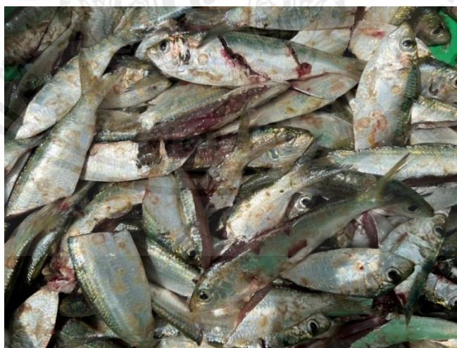
รูปที่ 4.21 ลักษณะของปลาเปิดที่ไม่เป็นชิ้น ความเร็วรอบ 1200 rpm
