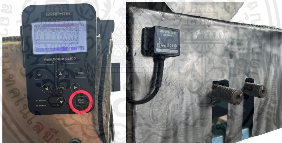
รูปที่ 3.36 เครื่องวัดอัตราเร่ง
