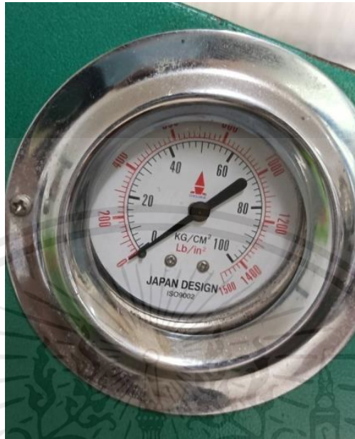
รูปที่ 3.3 เกจวัดความดันจากเครื่องอัดไฮดรอลิก
