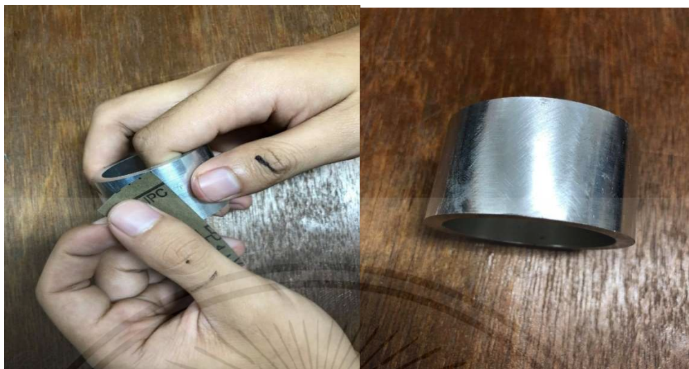
รูปที่ 3.7 ชัดชิ้นงานต้นแบบสำหรับมาร์คจุดติดสเตรนเกจ
