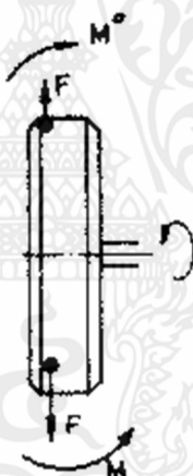
รูปที่ 2.14 การถ่วงล้อเพื่อให้เกิดความสมดุล [21]
