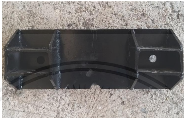
รูปที่ 3.11 เจาะรูทำช่องสายสัญญาณโพลดเซลล์
