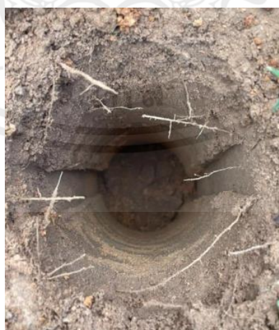
รูปที่ 4.7 ลักษณะการคงรูปของหลุม BBWS
