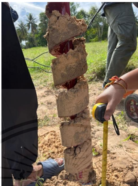
รูปที่ 4.10 ลักษณะความหนาแน่นของดินในระหว่างเกลียวของใบสกรู BBWS
