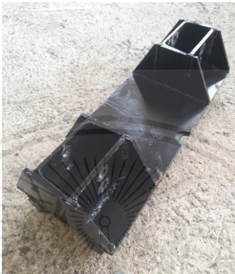
รูปที่ 3.15 เชื่อมครีบเสริมความแข็งแรง
