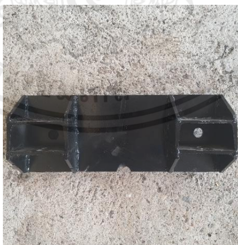
รูปที่ 3.14 เชื่อมกล่องยึดโพลดเซลล์กับแผ่นเหล็ก
