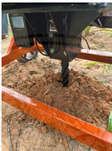
รูปที่ 3.46 ระดับความลึกที่ใบสกรูลงไปในดิน
