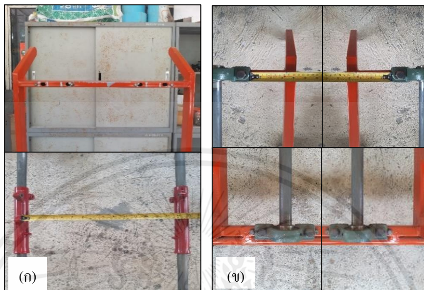
รูปที่ 3.9 (ก) มาร์คตำแหน่ง (ข) เจาะรูยึดตลับลูกปืนตึกตา
