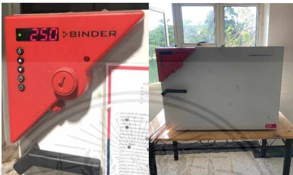
รูปที่ 3.15 เตาอบที่อุณหภูมิ 250 องศาเซลเซียส
