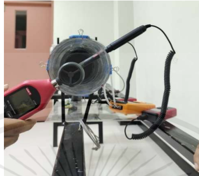
รูปที่ 3.34 การวัดความเร็วลม 3 จุดเพื่อให้ได้ค่าความเร็วลม 3 ค่าเพื่อนำมาเฉลี่ย
