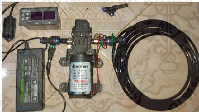
รูปที่ 3.10 ชุดปั้มน้ำและตัวควบคุมความชื้น
