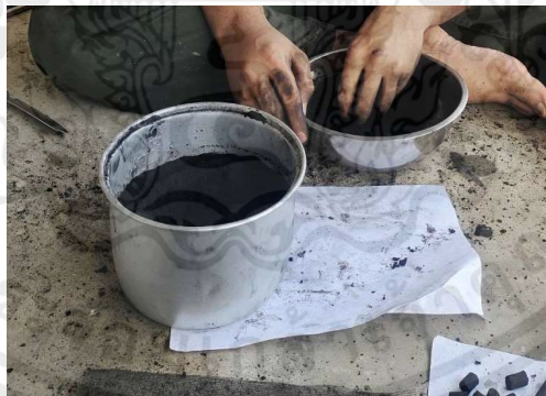
รูปที่ 3.25 คลุกเคล้าผงถ่านชาร์โคลกับแป้งให้เข้ากัน
