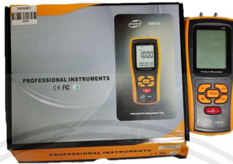
รูปที่ 3.18 เครื่องมือวัดความดันตกคร่อม ยี่ห้อ Benetech รุ่น GM510
