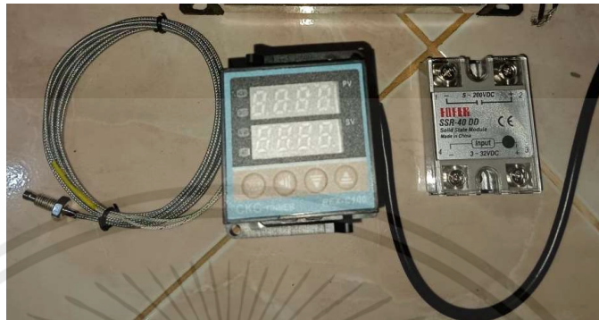
รูปที่ 3.9 ชุดควบคุมขดลวดความร้อน
