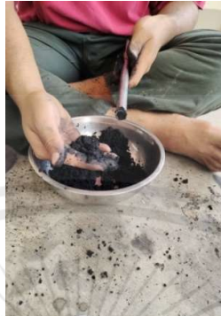
รูปที่ 3.26 การอัดผงถ่านซาร์โคลเข้าแท่งเหล็กทรงกระบอก
