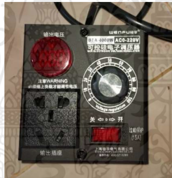
รูปที่ 3.8 อุปกรณ์ควบคุมแรงดันไฟฟ้า
