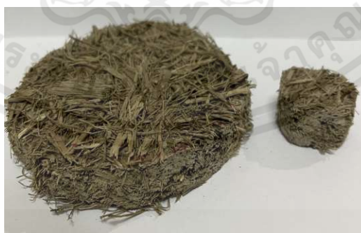
รูปที่ 3.29 ตัวอย่างชิ้นงานเส้นใยชานอ้อย 100 เปอร์เซ็นต์
