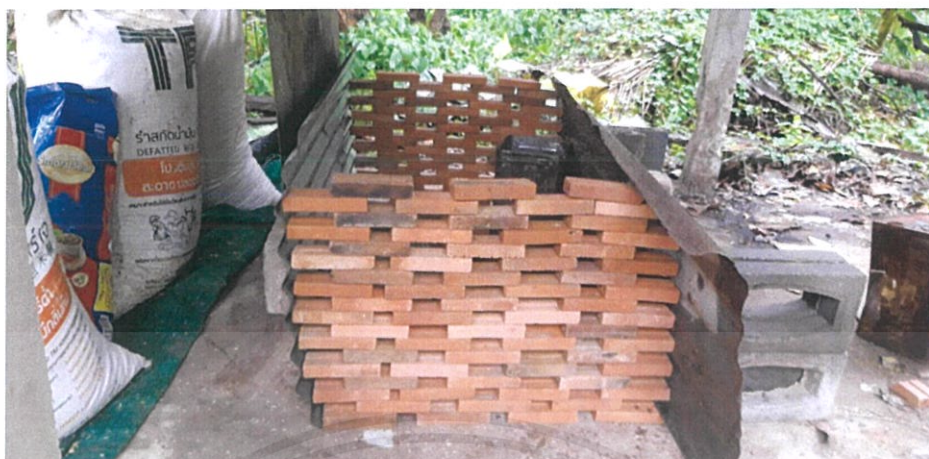
ภาพที่ 3.12 เตาเผาที่ทำจากอิฐมอญ
