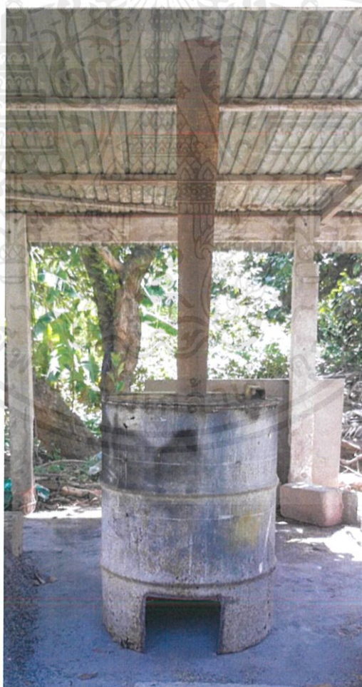
ภาพที่ 3.13 เตาเผาที่ทำจากถัง 200 ลิตร
