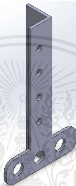
รูปที่ 3.37 แบบร่างขวยึดโซ่ค้ำขา
