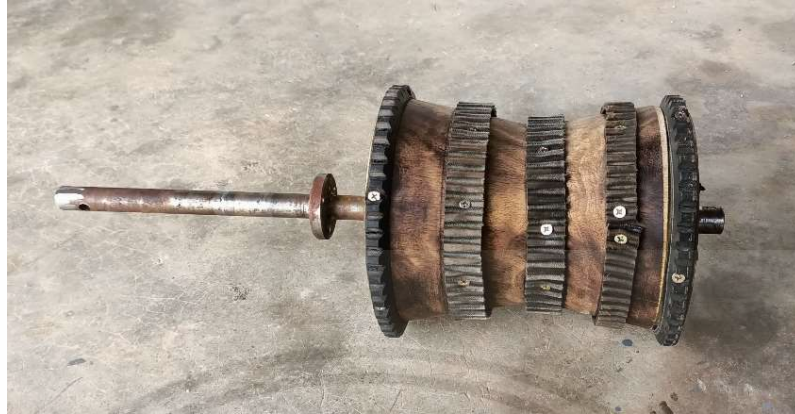
รูปที่ 3.9 ชุดเฟลาล้อไม้ทรงกรวย
