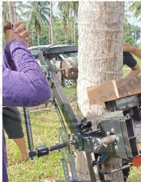
รูปที่ 3.59 ต่อทอร์คเซ็นเซอร์รุ่น DYN-200 เข้ากับเพลลาของล้อขับ
