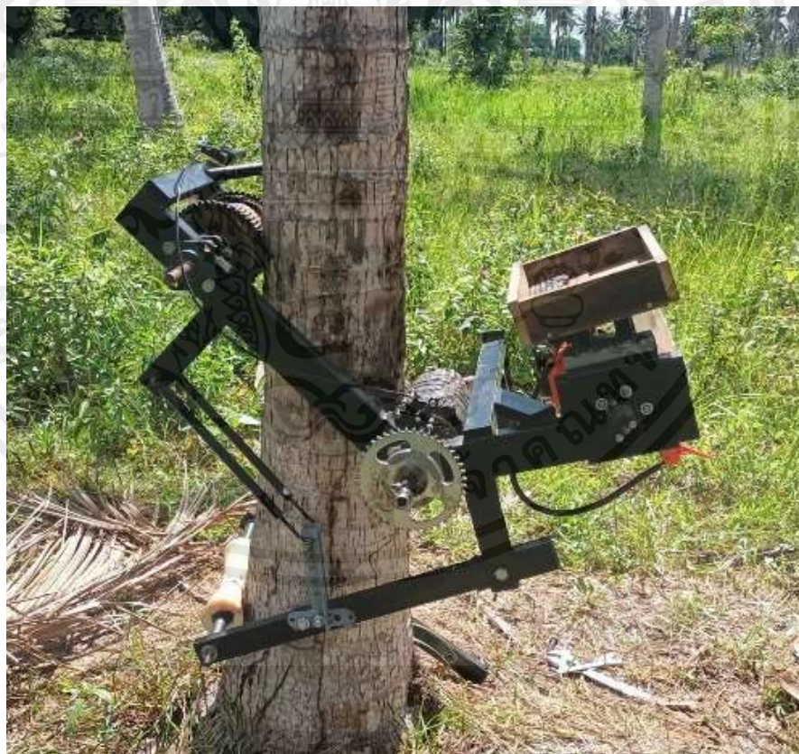
รูปที่ 3.57 การติดตั้งเครื่องป็นต้นมะพร้าวเข้ากับต้นมะพร้าว
