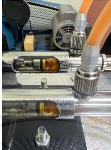
รูปที่ 4.3 ไชริงค์ไม่สามารถดูดน้ำมันปาล์มสกัดเย็นได้เต็มกระบอกทำให้เกิดค่าความผิดพลาดเยอะ
