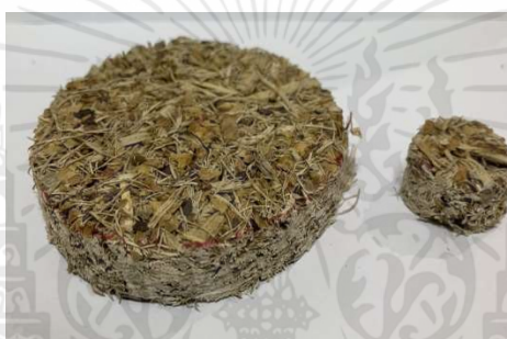
รูปที่ 3.21 ตัวอย่างชิ้นงานแบบเส้นใยอ้อย 50% ผสมเปลือกกะลากาแฟ 50% ความสูง 20 มิลลิเมตร เส้นผ่านศูนย์กลาง 30 มิลลิเมตรและ 100 มิลลิเมตร
