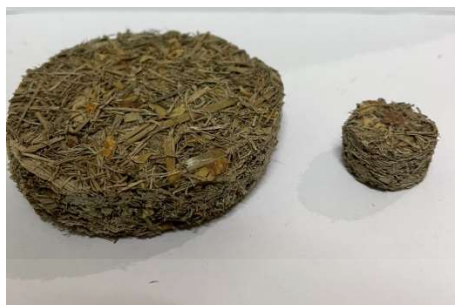
รูปที่ 3.20 ตัวอย่างชิ้นงานแบบเส้นใยอ้อย 75% ผสมเปลือกกะลากาแฟ 25% ความสูง 20 มิลลิเมตร เส้นผ่านศูนย์กลาง 30 มิลลิเมตรและ 100 มิลลิเมตร
