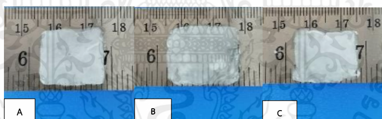
รูปที่ 4.6 วัสดุปิดแผลที่ขึ้นรูปจากอัตราส่วน 50 : 50 และใส่ยา Chlorhexidine gluconate 10%
