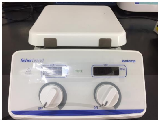
รูปที่ 3.9 เครื่องกวนสารให้ความร้อน (Hotplate)
