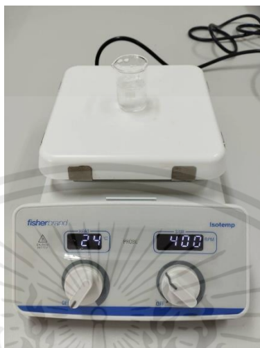
รูปที่ 3.13 PVA CMC PEGDA ที่กวนเข้ากันเติมยา Chlorhexidine gluconate
