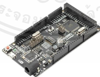
รูปที่ 2.6 บอร์ด Arduino mega 2560 Wifi (ที่มา: https://www.arduino4.com/product )
