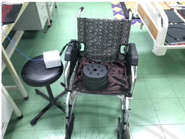
รูปที่ 3.53 การทดลองเซนเซอร์ FSR
