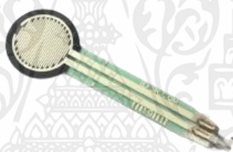
รูปที่ 2.7 Force Sensitive Resistor (FSR)
