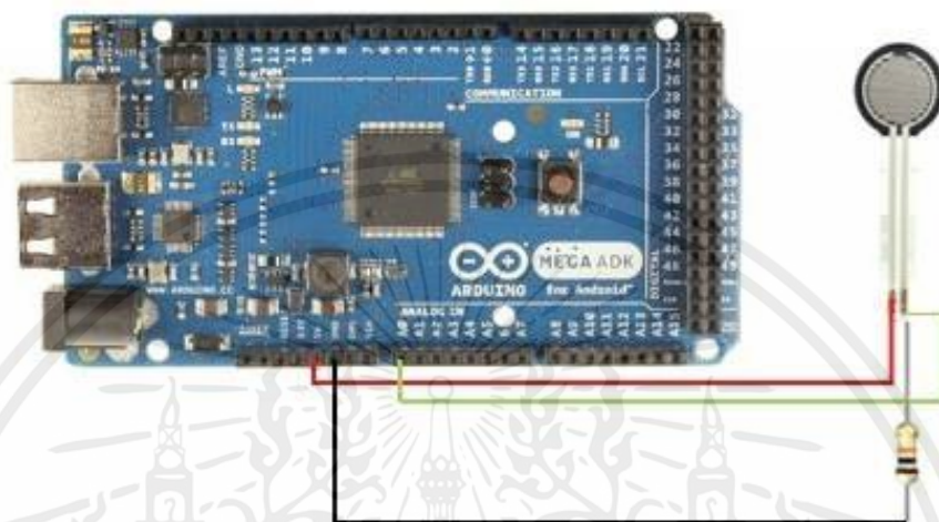
รูปที่ 3.25 วงจรต้นแบบที่ใช้ระหว่างเซนเซอร์และไมโครคอนโทรลเลอร์
