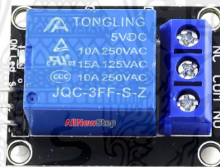
รูปที่ 2.22 Relay Module
